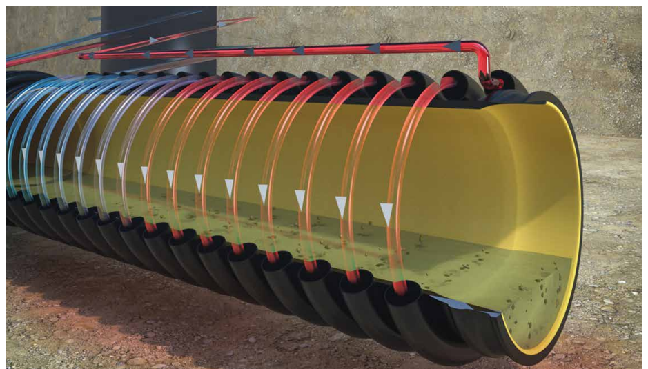
Der wickelförmige Stützschrlauch fungiert als Wärmetauscherelement
